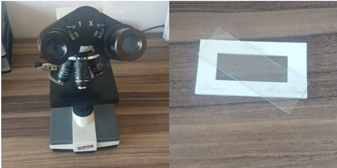
Figura 12 - Microscópio óptico biológico usado para as análises de zooplâncton e câmara de contagem modelo Sedgewick-Rafter milimetrada
