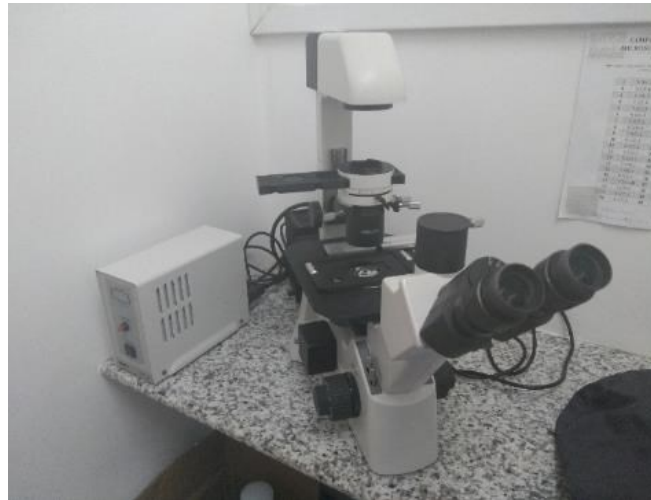
Figura 10 – Análise das comunidades planctônicas em microscópio invertido
