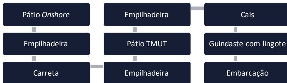
Figura 58 – Fluxograma da movimentação de produtos siderúrgicos no Terminal Portuário do Pecém Elaboração: LabTrans/UFSC (2019)
