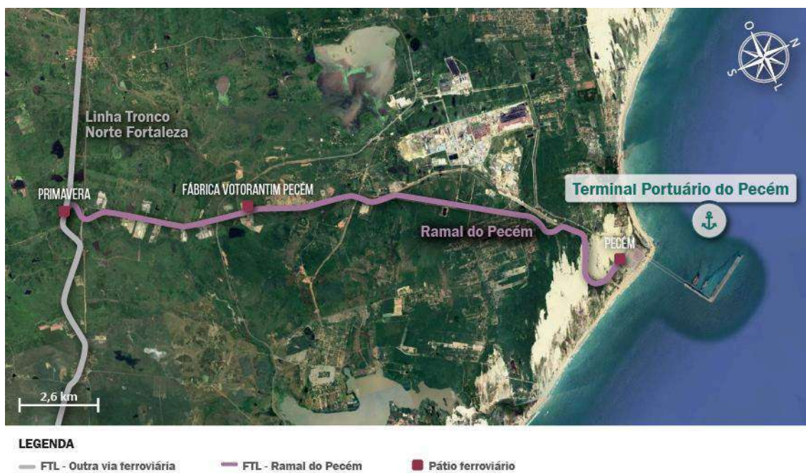
Figura 106 – Ramal de Pecém, concedido à FTL, no acesso ferroviário ao Terminal Portuário do Pecém Fonte: ANTT ([2018]) e Google Earth (2019). Elaboração: LabTrans/UFSC (2019)
