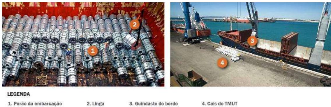
Figura 60 – Operação de desembarque de bobinas no Terminal Portuário do Pecém Fonte: CIPP (2019a). Elaboração: LabTrans/UFSC (2019)
