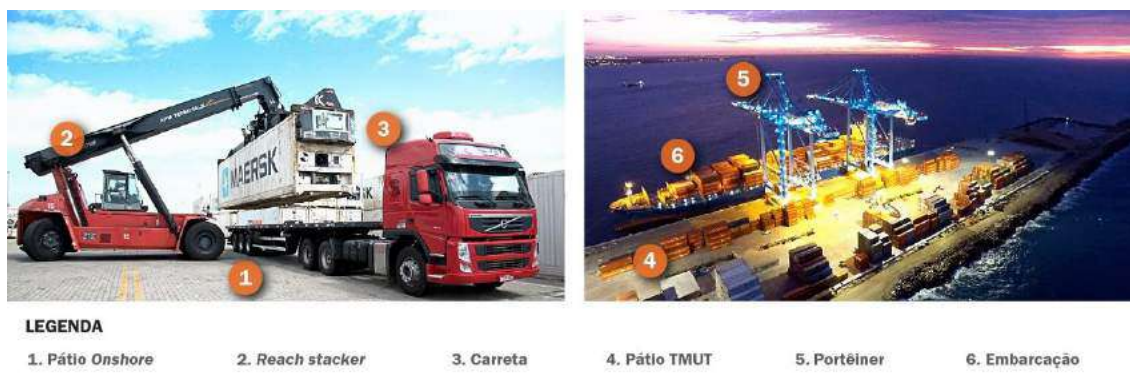
Figura 62 – Movimentação de contêineres no Terminal Portuário do Pecém Fonte: CIPP (2019a). Elaboração: LabTrans/UFSC (2019)
