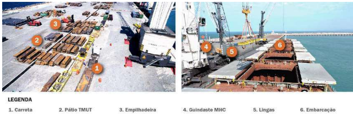
Figura 59 – Operação de embarque de placas de aço no Terminal Portuário do Pecém Fonte: CIPP (2019a). Elaboração: LabTrans/UFSC (2019)
