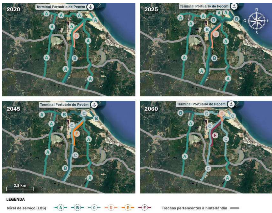
Figura 193 – LOS dos acessos rodoviários em 2020, 2025, 2045 e 2060: entorno do Terminal Portuário do Pecém Elaboração: LabTrans/UFSC (2019)
