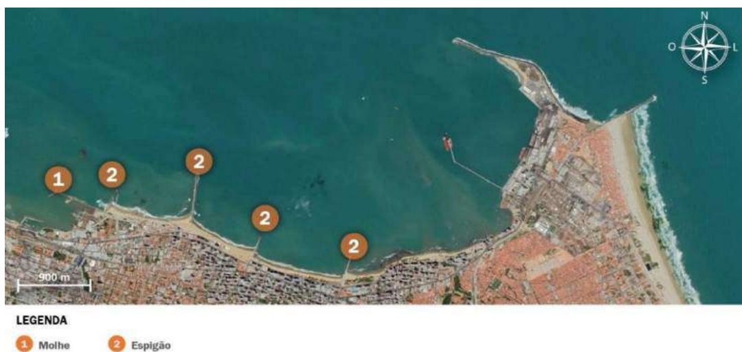
Figura 24 – Espigões e molhe localizados próximo ao Porto de Fortaleza Fonte: Google Earth (2019). Elaboração: LabTrans/UFSC (2019)
