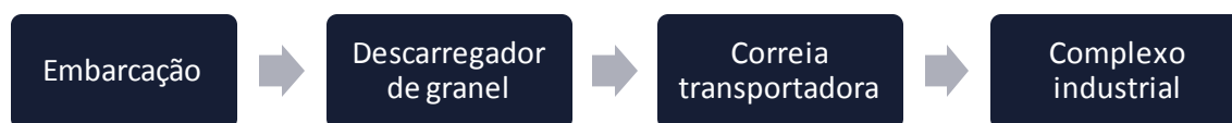
Figura 57 – Fluxograma do desembarque de granéis sólidos minerais no Terminal Portuário do Pecém Elaboração: LabTrans/UFSC (2019)
