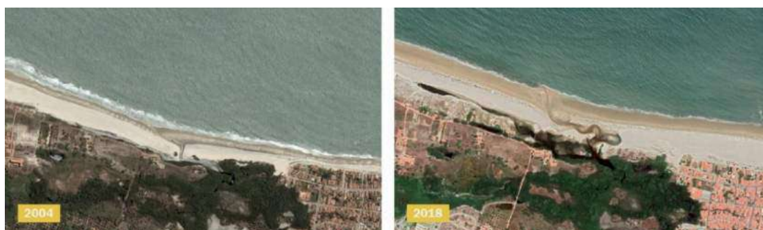
Figura 160 – Processo de sedimentação na Praia do Pecém, à esq. em 2004 e à dir. em 2018 Fonte: Google Earth (2019). Elaboração: LabTrans/UFSC (2019)
