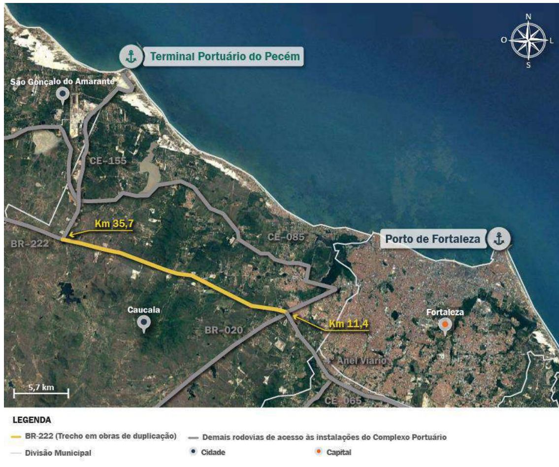
Figura 115 – Trecho contemplado pelas obras de duplicação da BR-222 Fonte: DNIT (2019a) e Google Earth (2019). Elaboração: LabTrans/UFSC (2019)
