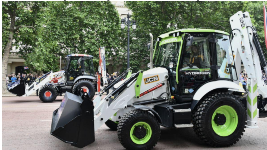
Figura 32 – Carregadeira JCB com motor de hidrogênio
